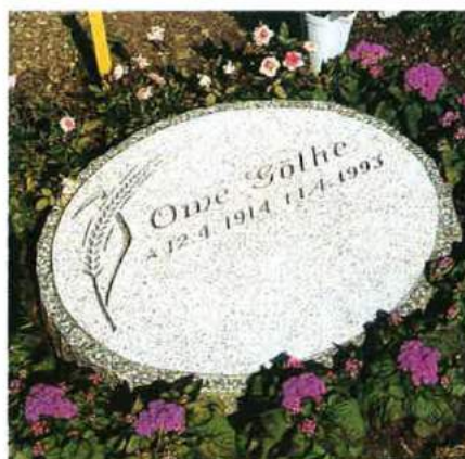
F35-822 Mörkgrå GS granit. Ovansidan finhuggen, kanterna råtillsatta, kantslaget spetsmejslat, djupblästrad dekor och text.
