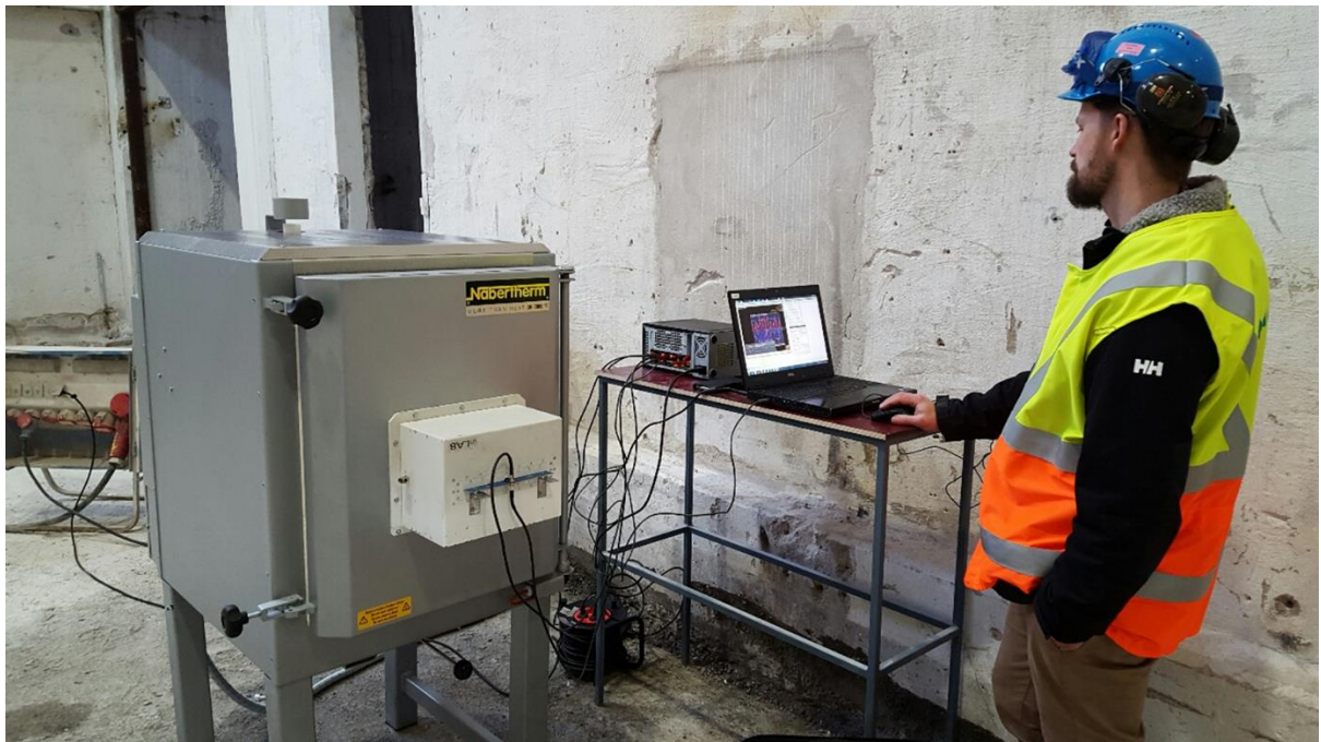
Figur 5. Specialbyggd keramikugn med radiomätutrustning.
