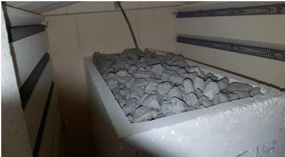
Figur 4. Behållare med kalksten och temperaturelement nedstucket i kalkstenen.
