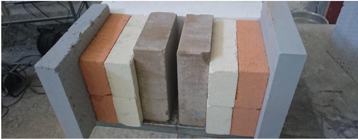
Figur 20. Fyra lagars isolering upphettades och mättes. Blågrå=lättast material, rött=lättare material, vit=tyngre material, grå=tyngst material.
