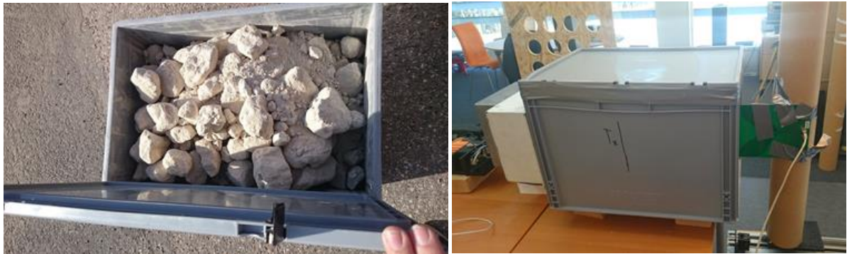
Figur 2. a) Bränd kalk. b) Radiomätssystem för mätning av kalcineringsgrad i bränd kalk på provlåda.
