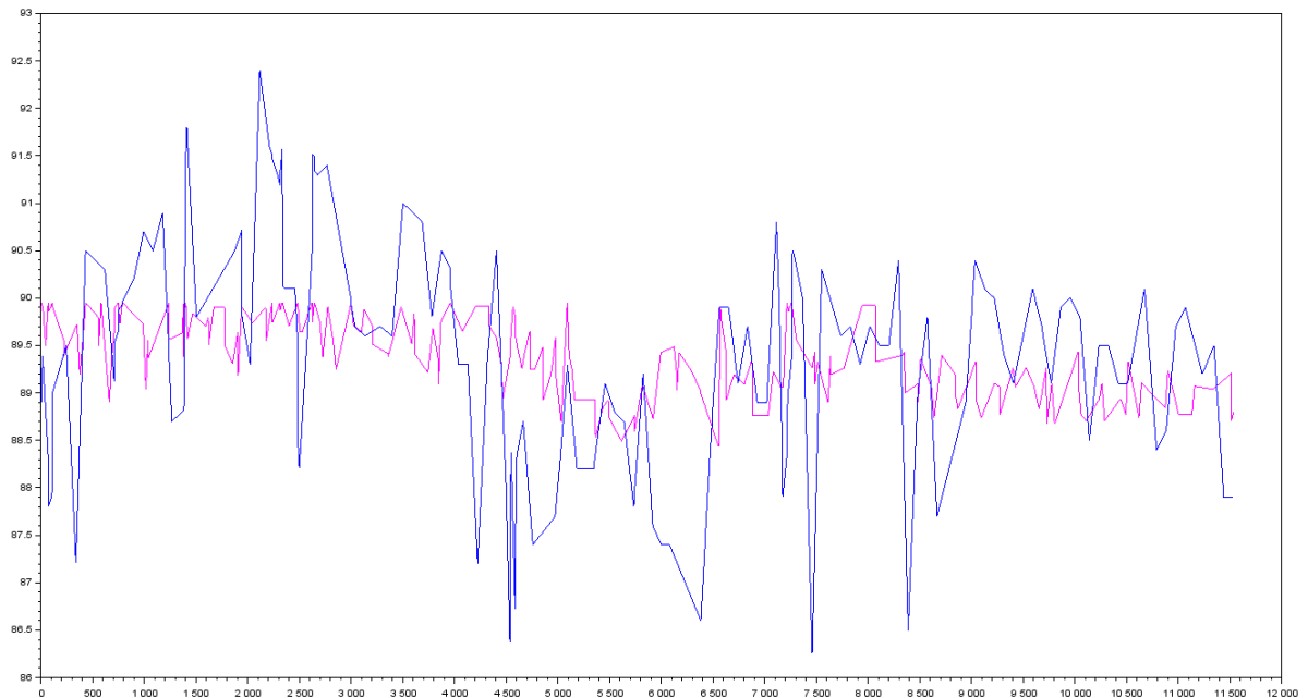
Figur 18. Mätt temperatur (blå). Beräknad kalcineringsgrad (lila) från temperatur med eliminering av grova fel ( \sigma=1,003 pe) för data \geq +940^{\circ}\text{C} , ekvation 4.
