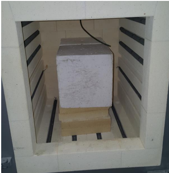
Figur 4.16. Värmning och mätning i laboratorieugn av keramer och Saffil.
