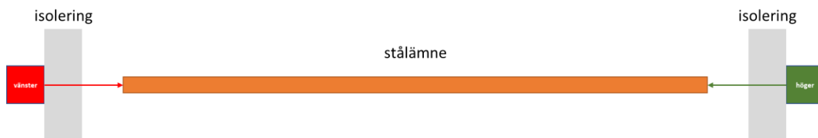
Figur 6.8. Mätuppställning (sett ovanifrån) med två sensorer, isolering och stålämne.
