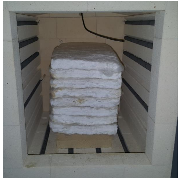
Figur 4.16. Värmning och mätning i laboratorieugn av keramer och Saffil.
