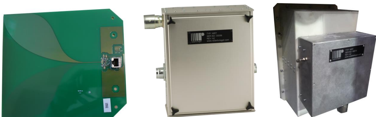
Figur 3.3. Äldre sensorn bestående av a) två Vivaldi-antenn och b) Wideband Radar Transceiver, WRT. c) Utvecklat antennhus för bättre signal, noggrannhet och styrka.
