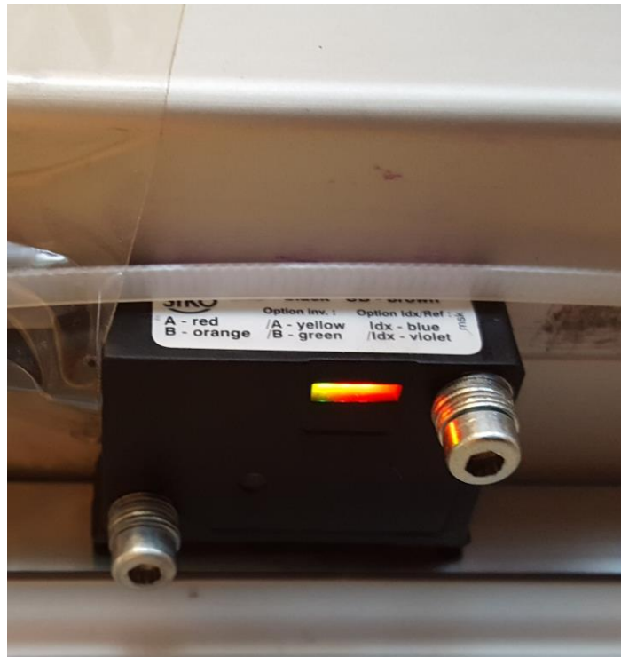
Figur 5.5. a) Linjärenhet för förflyttning av radarmål. b) Magnetsensor för noggrann positionsbestämning.
