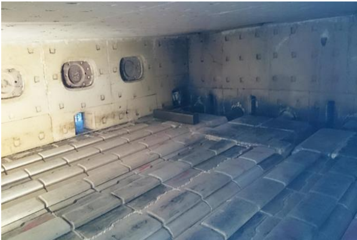
Figur 1.1. Värmningsugn Ugn62 på Sandvik. Fotot är tagit med ett litet lätt testämne. Luckan till vänster är en inspektionslucka. Chargering i luckan sker längst inne i hörnet.
