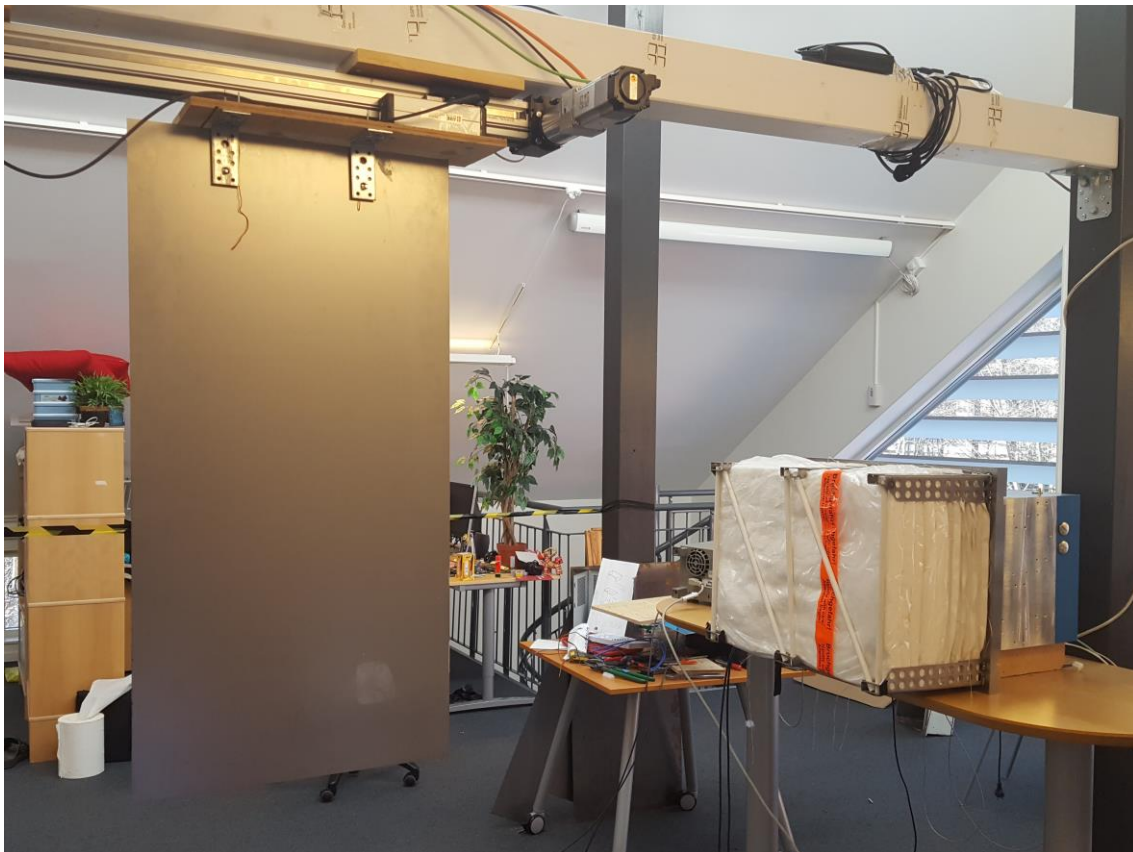
Figur 5.6. Mätupställning för mätning i med antennhus med fiberisolering och stålplåt (1 mm).
