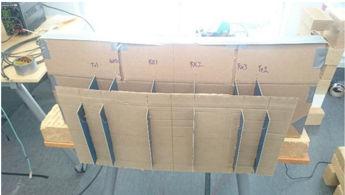
Figur 7.2. Gles array med sex fixerade antenner på en pappskiva.
