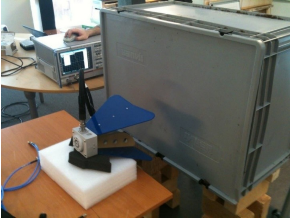
Figur 1. Transmissionsmätning med nätverksanalysator och hornantenn på provlåda.
