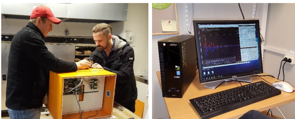
Figur 21. Hopbyggnad av sensor samt dator för övervakning av radarsystem, temperatursensor och kamera.
