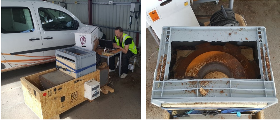
Figur 7. Densitetsmätning gjordes genom att successivt öka trycket på träflisen med vikter från 0–116 kg.
