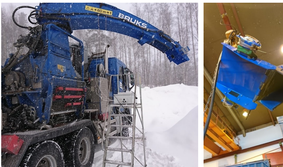
Figur 34. Huggmaskin och en utkastare. Radiomätssystemet är monterat längst ut på själva utkastaren.
