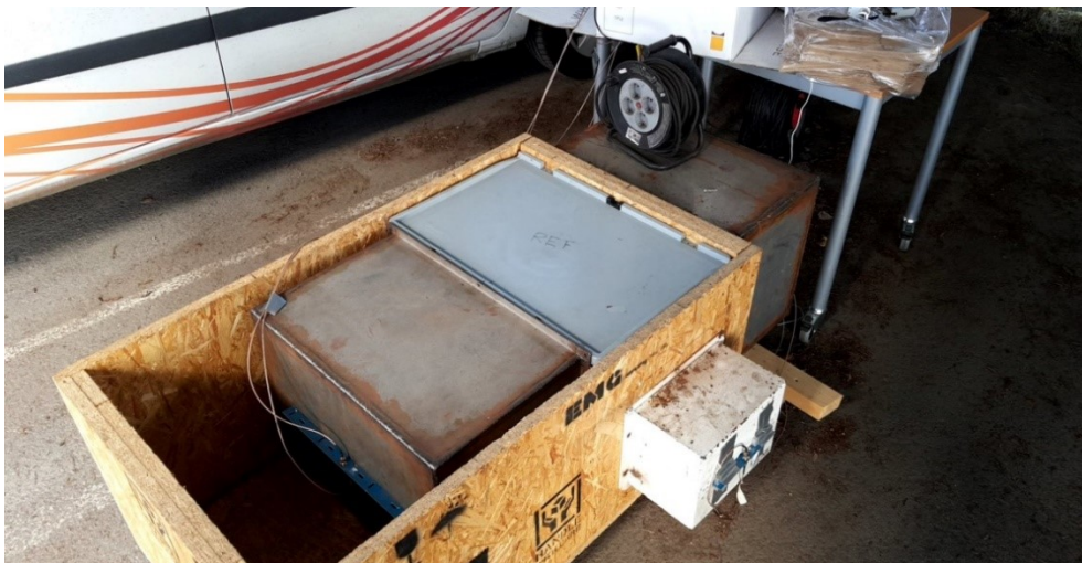
Figur 9. Mättrigg med två olika storlekar på antennhus (stor=stålfärg, liten=vit färg). Grå provlåda i plast innehöll träflis.
