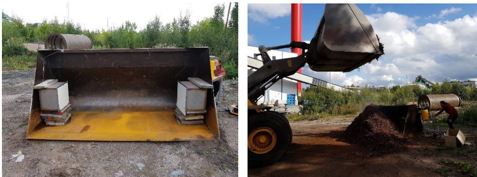
Figur 27. Mätning i skopa med antennhus och påfylld av träflis.
