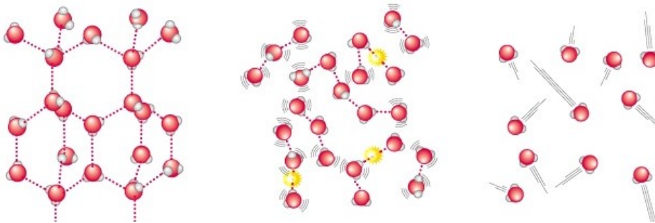
Figur 5. a) Fruset vatten med tre vätebindningar, b) Tempererat vatten med vätebindningar till syreatom, och c) Ånga utan bindningar (bild från: Sinauer Associates).
