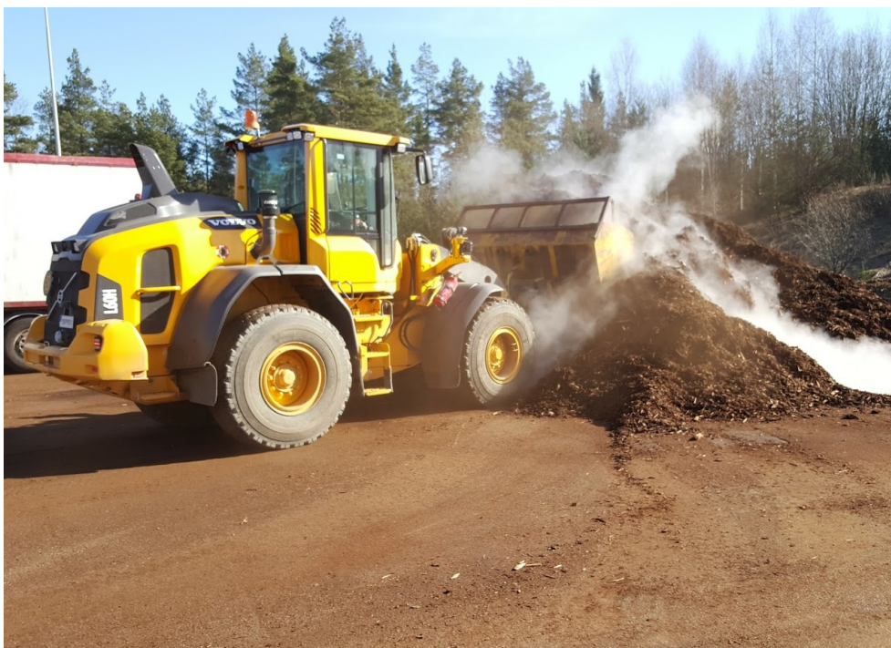
Figur 25. En hjullastare med en så kallad högtippningsskopa för lastning av en lastbil.
