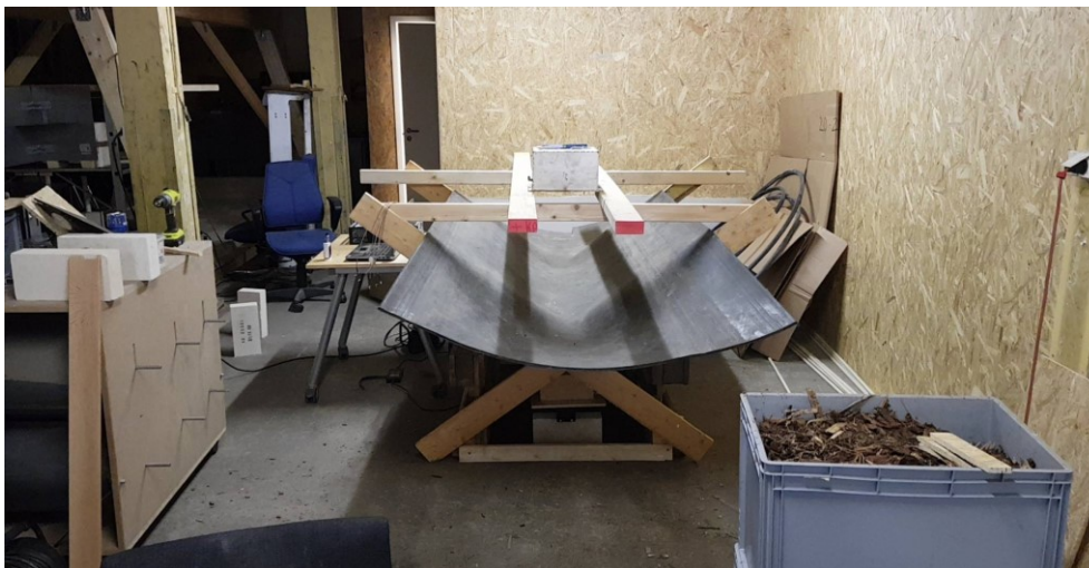
Figur 30. Mätuppställning av radiomätutrustning på transportband.
