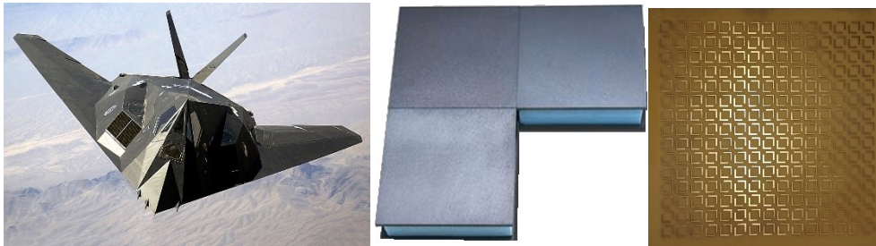
Figur 39. a) Stealth-teknik på stridsflygplan används för att minska reflektionen av radiosignaler. Absorberande material används på kanter, i hörn och i skarvar. b) Ferritiskt absorptionsmaterial från Holland Shielding system. c) Flerskiktig metamaterial utvecklat av Radarbolaget och Högskolan i Gävle
