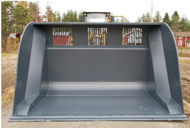
Figur 29a. Skopa med möjlig placering av antenner i sidorna (bild: www.ypv.se ).
