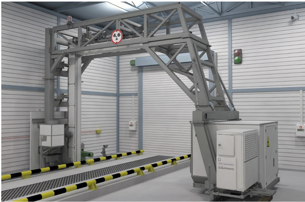
Figur 42. Skanning av stillastående lastbil. I detta fall en röntgenskanner med guiderör. Guiderören gör att fordonet inte kan köra snett eller ligga i fel sida.
