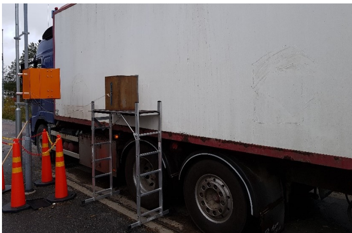
Figur 19. Mätuppställning med flyttbara sensorer (rostfärgad) i vertikal riktning.
