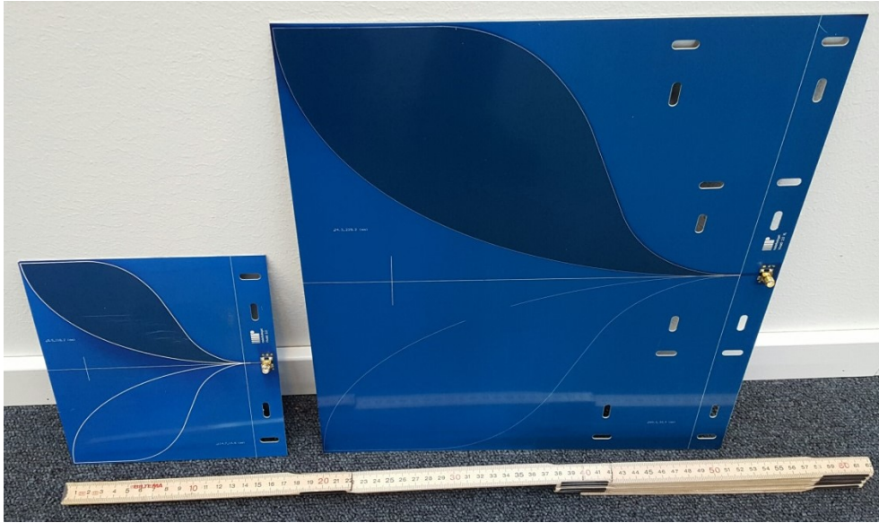
Figur 2a. Vivaldi-antennor: 2 GHz-antenn i jämförelse med 0,75 GHz-antenn
