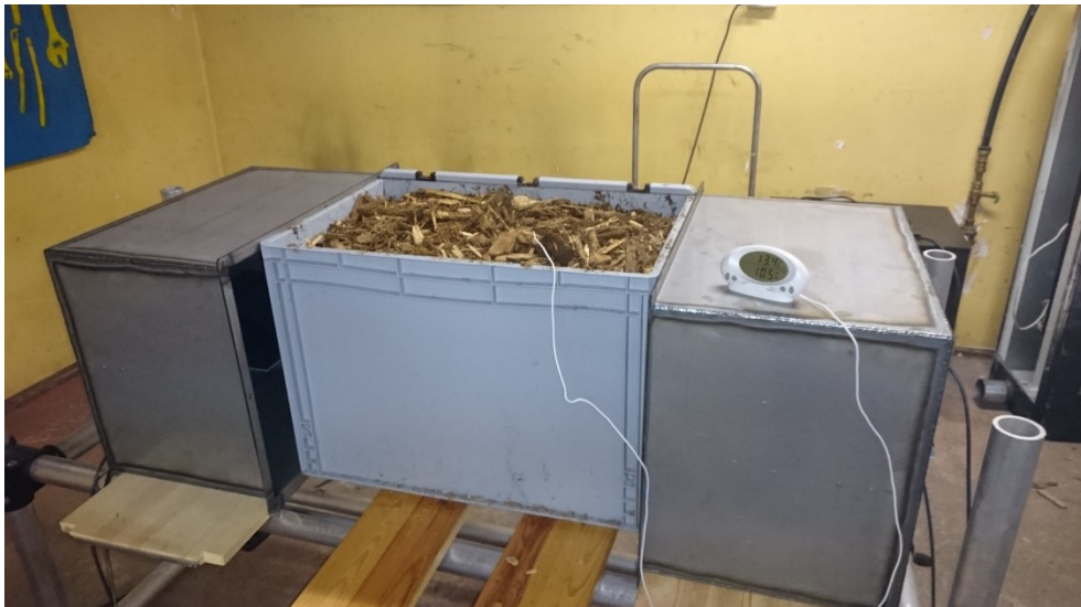
Figur 2b. Uppställning av radiolänkutrustning för mätning på provlåda
